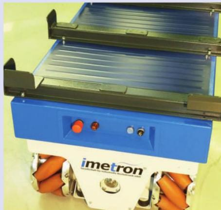
*Das Mecanum Fahrwerk ist als modulare und skalierbare Grundeinheit konzipiert. Das Fahrzeug trägt Lasten bis 2.000 kg.*
